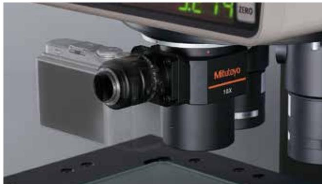
Exemplo de fixação da lente de projeção 10X com montagem C no PJ-H30
