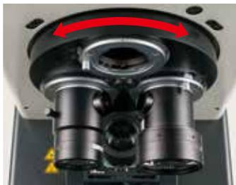
O revólver da série **PJ-H30** usa rolamentos de baixa fricção que permitem um movimento giratório suave e rápido para alterar a ampliação, trazendo diferentes lentes de projeção para a trajetória da luz. O corpo da torreta usa montagens de baioneta para ajudar na fixação e no desprendimento rápido das lentes.
