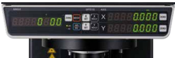
Uma vez que o contador digital (eixos X, Y e ângulo) integrado em todos os modelos de série utiliza um LED de alta intensidade e um visor de caracteres grandes, garante uma alta visibilidade não afetada pelo ambiente. Além do ajuste de zero e da mudança de direção, a saída de dados de cada valor do contador adota o RS-232C altamente versátil.
