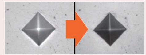
Observação da imagem da indentação (50X) Redução de luz difusa na zona da indentação
