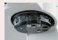
Revólver motorizado com montagem de 2 indentadores e 4 objectivas
