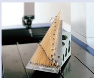
Calibração de CMM , utilização de padrão em vidro com expansão térmica virtualmente zero
