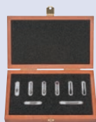
Calibração de CMM , utilização de padrão em vidro com expansão térmica virtualmente zero
