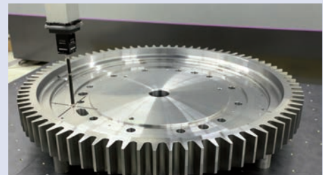
Scanning com a ponteira SP80 e ponta 100 mm.
